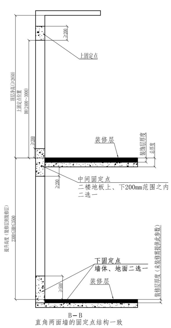
1. 当下固定点, 选在墙体时, 提升高度应为1层装修完成面到2层装修完成面的高度;
